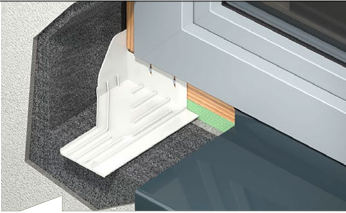
Mit dem Entwässerungsmodul Gutmann Delta werden die Probleme gelöst, die häufig in den Eckbereichen durch undichte Bauanschlussfugen vorhanden sind.
